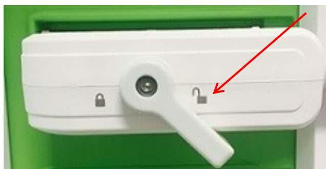
Afbeelding 9: Vergrendelknop transducerconnector in ontgrendelde stand
